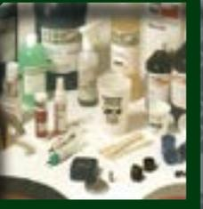
拋光完後的試片表面猶如鏡面，在顯微鏡下觀察時，除了有色組成物、孔洞及其他研磨缺陷外，由於表面光滑反射光甚強，無法判別其組織，故應以化學溶液侵蝕其表面。
