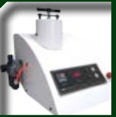
當切取之試片太薄或過小，或想觀察試片邊緣組織時，試片通常需要進行鑲埋的動作，鑲埋基技術分為熱鑲埋法及冷鑲埋法兩種。
