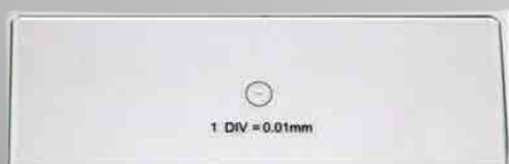
單軸刻度玻璃校正片 最小切分：一格 0.01mm(10um)
