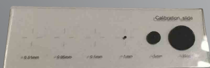
圓形玻璃校正片 6 個圓形標定尺寸 10mm、5mm、1mm、0.1mm、0.05mm、0.01mm
