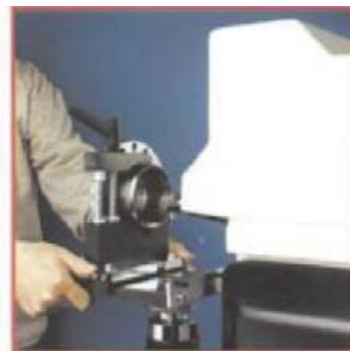
量測齒輪箱內部零件硬 度
