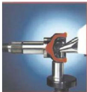
量測傳動軸的內孔表面 硬度
