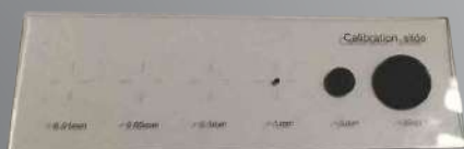
圓形玻璃校正片 6 個圓形標定尺寸 10mm、5mm、1mm、0.1mm、0.05mm、0.01mm
